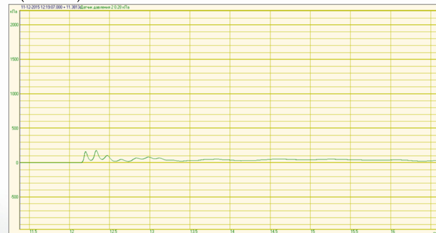
Bild 2 - Hydrostoßkurve mit installierten Stabilisator (DN 200)
